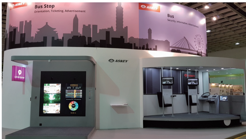
圖 1：「智慧候車亭」能即時感測、顯示溫濕度，以及 PM 2.5 / 一氧化碳 / 二氧化碳 / 二氧化硫等空氣品質指標
