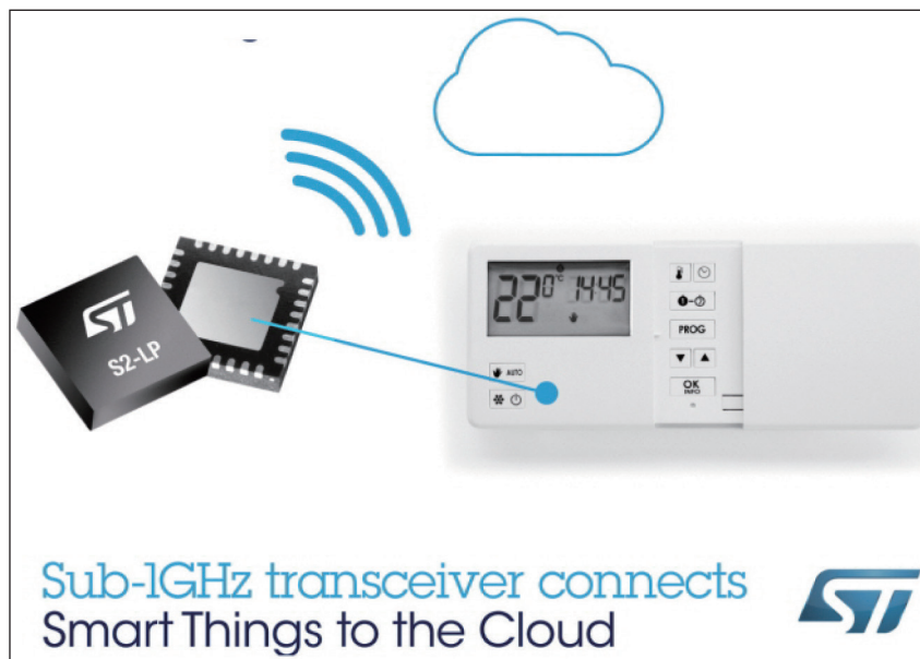
圖 1：S2-LP 是免授權頻段的 sub-GHz 低功耗射頻收發器晶片，接收模式工作電流僅 6.7mA，睡眠和待機模式分別降到 600nA 和 350nA
