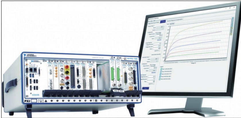
圖 1：利用 PXI 高速傳輸、低延遲特性，在 PXI 背板上觸發 SMU，能同步化高速數位 I/O、RF 分析器／產生器、高速示波器量測資料，方便系統規劃擴充
