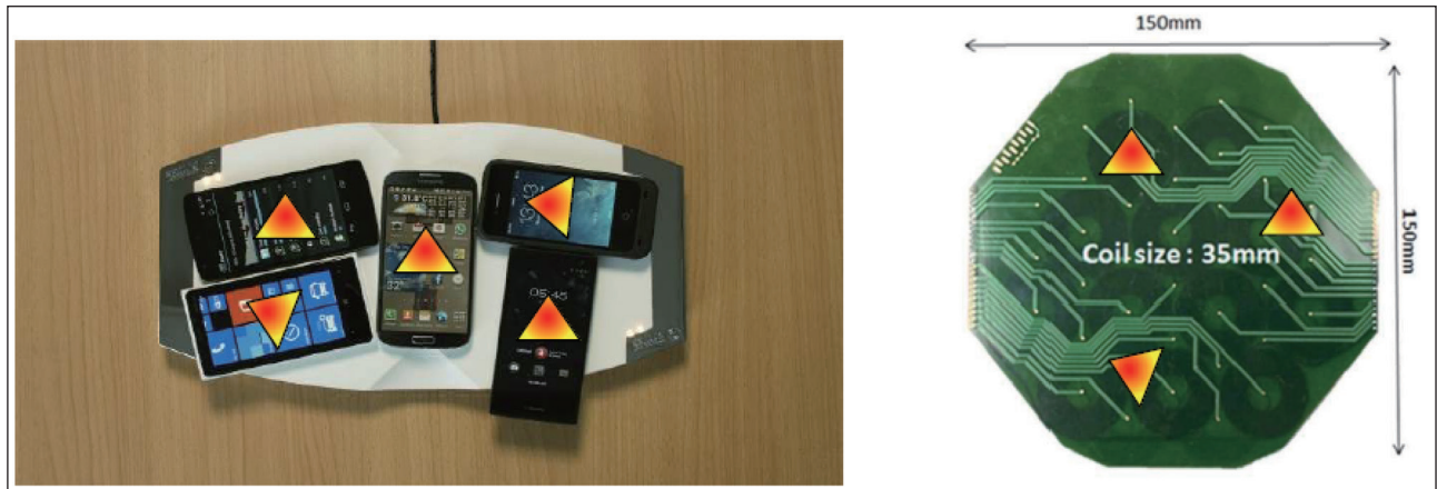
圖 5：發送端的線圈設計，會影響裝置擺放位置及充電效率
