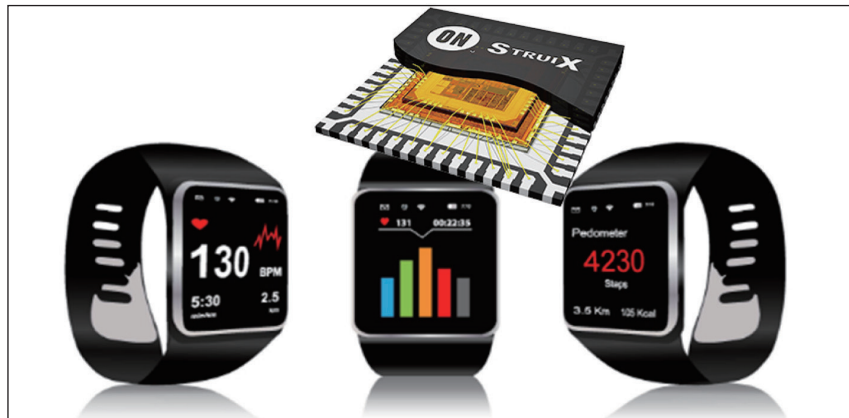
圖 7：「Struix」取義自拉丁語「stacked」(堆疊)，意指將客製晶片和標準晶片疊在一個封裝中
