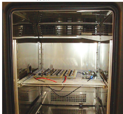
圖 1：在一個高低溫試驗箱中工作的 SmartMesh 節點
