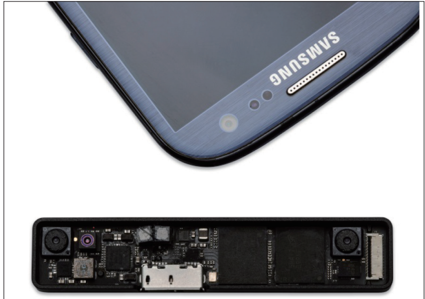
圖 4：Inuitive 公司的 NU3000 處理器包含成像與電腦視覺向量 DSP 內核
