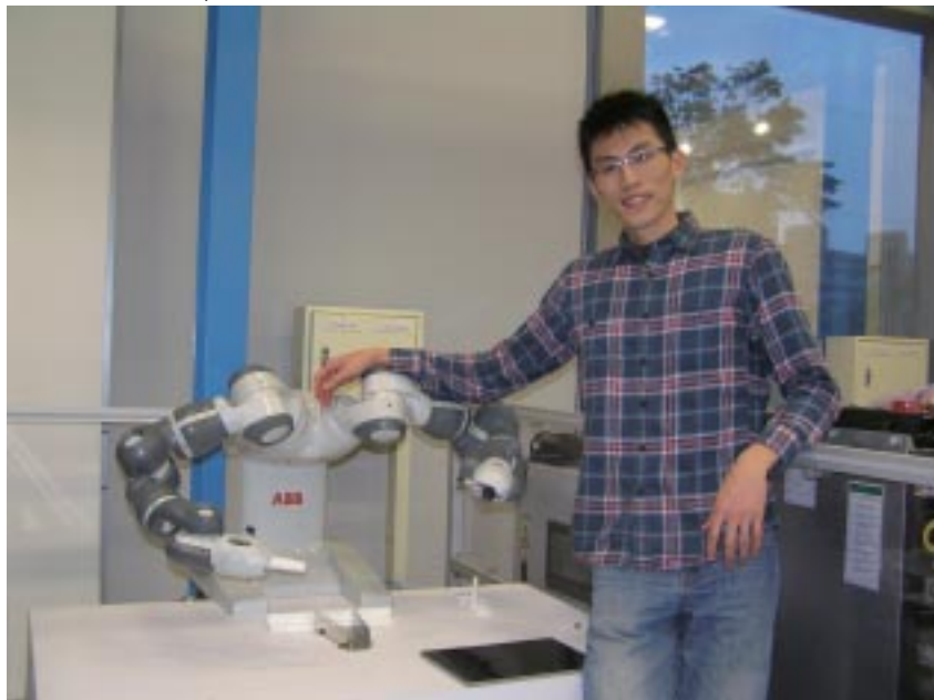
圖 3：ABB 專為小零件組裝應用所設計的人機協作雙臂機器人 YuMi，讓操作員能與機器人並肩工作，無需安全圍籬
