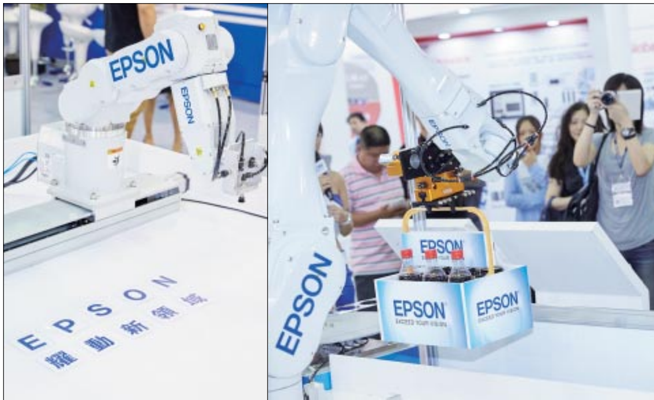
圖6：精工愛普生(Epson)新型ProSix六軸機械手臂C8XL，擁有更高的荷重及臂長；而第七軸的新型升級應用，可透過Epson的PG(Pulse Generate)卡，使線性滑軌與機械手臂同時動作，CP值高。
