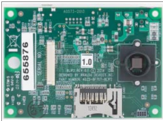
圖說：ADSP-BF706 EZ-KIT Mini 開發平臺
