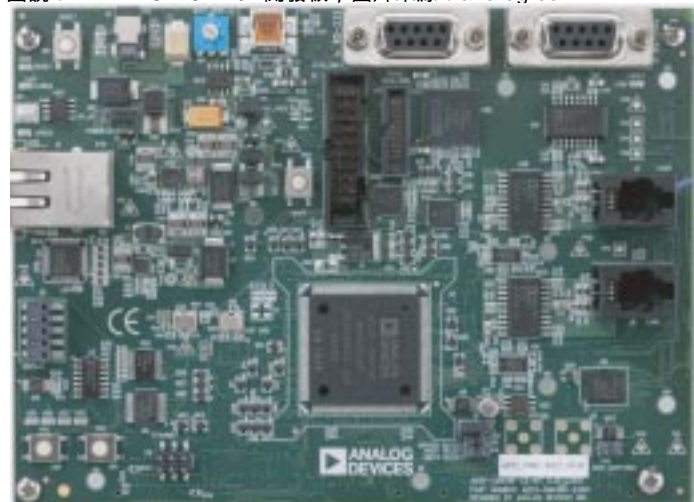
圖說：ADI ADSP-CM40x 開發板，圖片來源：analog.com
